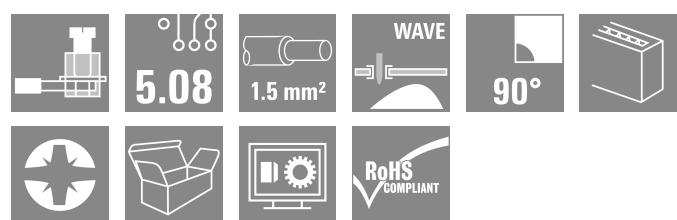
Klein, kompakt und leistungsstark – diese Leiterplattenklemme mit bewährtem Zugbügelanschluss im Raster 5,08 mm verfügt über eine Tragfähigkeit von 17,5 A. Leiterabgangsrichtung in 90°-Ausführung. Für Leiterquerschnitte bis 1,5 mm<sup>2</sup> geeignet.
