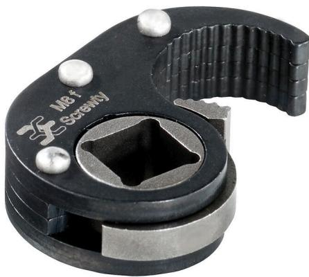
Der Screwty® Aufsatz ist für freikonfektionierbare M8 Rundsteckverbinder, mit einem Außenmaß der Rändelmutter von  $11,9 \pm 0,3$  mm, geeignet. Das Anzugsdrehmoment liegt bei 0,5-0,6 Nm.
