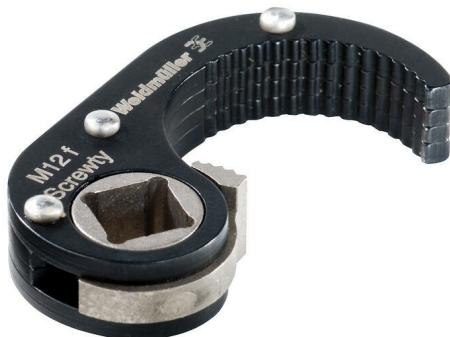
Der Screwty® Aufsatz ist für freikonfektionierbare M12 Rundsteckverbinder, mit einem Außenmaß der Rändelmutter von  $19,8 \pm 0,3$  mm, geeignet. Das Anzugsdrehmoment liegt bei 0,8-1,2 Nm.
