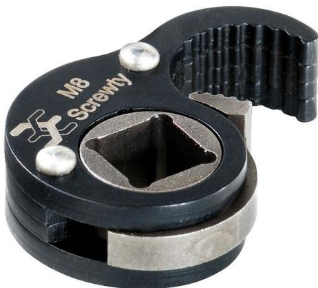
Der Screwty® Aufsatz ist für M8 Rundsteckverbinder, mit einem Außenmaß der Rändelmutter von  $10 \pm 0,3$  mm, geeignet. Das Anzugsdrehmoment liegt bei 0,5-0,6 Nm.
