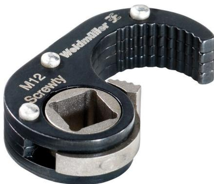
Der Screwty® Aufsatz ist für M12 Rundsteckverbinder, mit einem Außenmaß der Rändelmutter von  $14,5 \pm 0,3$  mm, geeignet. Das Anzugsdrehmoment liegt bei 0,8-1,2 Nm.
