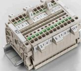
Die Bezeichnungsträger bieten die Möglichkeit der zusätzlichen Aufnahme von Standard Markierern im Raster von 5 bzw. 5.1 mm. Die gewinkelten Aufnahmen lassen sich wahlweise über miteinander verrasten und lassen sich in allen Standard Markierungskanälen der Klippon® Connect Reihenklemmen montieren. Passende Markierer typen befinden sich unter dem jeweiligen Zubehör der Bezeichnungsträger.
