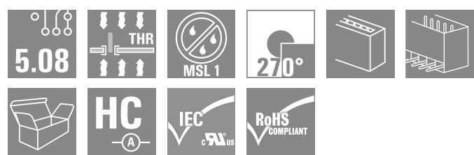
Hochtemperaturfeste, gerade, offene Stiftleiste. Verpackung in Box oder Tape. Im Tape und mit 1,5 mm Lötstift optimiert für die Automatenbestückung. Lötstift 3,2 mm für Reflow- und Wellenlötanwendungen geeignet. Die Stifteleisten sind beschriftbar und können kodiert werden. HC = High Current.
