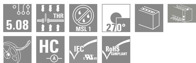
Hochtemperaturfeste, gerade, offene Stifteleiste. Verpackung in Box oder Tape. Im Tape und mit 1,5 mm Lötstift optimiert für die Automatenbestückung. Lötstift 3,2 mm für Reflow- und Wellenlötanwendungen geeignet. Die Stifteleisten sind beschriftbar und können kodiert werden. HC = High Current.
