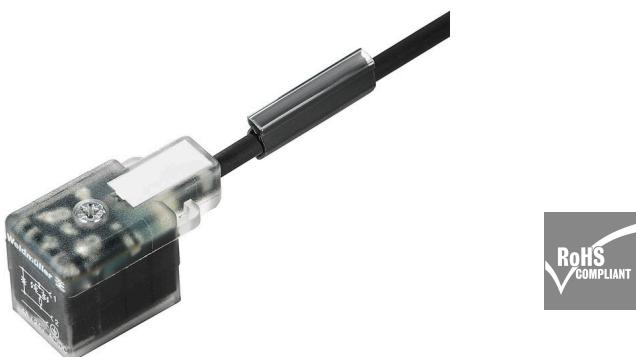
Weidmüller bietet Ventilstecker als Verbindungsleitung mit M8/M12 Steckern und mit freiem Leitungsende an. Der Betriebszustand des Ventilsteckers wird durch ein LED angezeigt. Die Ventilstecker besitzen eine Schutzbeschaltung. Das Weidmüllerlieferprogramm umfasst Ventilstecker der Bauformen A, B, C nach DIN und Industriestandard. Die Schutzart IP 67 wird im verschraubten Zustand erfüllt. Die Abgangsrichtung ist gleichfalls entscheidend, daher bietet Weidmüller unterschiedliche Versionen an.
