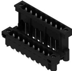
Hochtemperaturfeste, doppelstöckige, seitlich versetzte, Stiftleiste mit Flansch bzw. Lötplansch. Lötstift 1,5 mm für Reflowlötanwendungen geeignet. Lötstift 3,2 mm für Reflow- und Wellenlötanwendungen geeignet. Die Stiftleisten bieten Platz für Beschriftungen und können kodiert werden.
