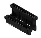
Hochtemperaturfeste, doppelstöckige, seitlich versetzte, Stiftleiste mit Flansch bzw. Lötflansch. Lötstift 1,5 mm für Reflowlötanwendungen geeignet. Lötstift 3,2 mm für Reflow- und Wellenlötanwendungen geeignet. Die Stiftleisten bieten Platz für Beschriftungen und können kodiert werden.
