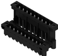
Hochtemperaturfeste, doppelstöckige, seitlich versetzte, Stifteleiste mit Flansch bzw. Lötflansch. Lötstift 1,5 mm für Reflowlötanwendungen geeignet. Lötstift 3,2 mm für Reflow- und Wellenlötanwendungen geeignet. Die Stifteleisten bieten Platz für Beschriftungen und können kodiert werden.
