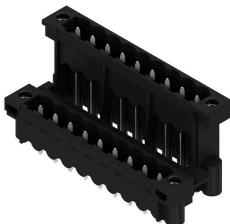
Hochtemperaturfeste, doppelstöckige, seitlich versetzte, Stifteiste mit Flansch bzw. Lötflansch. Lötstift 1,5 mm für Reflowlötanwendungen geeignet. Lötstift 3,2 mm für Reflow- und Wellenlötanwendungen geeignet. Die Stifteisten bieten Platz für Beschriftungen und können kodiert werden.
