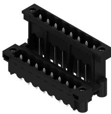
Hochtemperaturfeste, doppelstöckige, seitlich versetzte, Stiftleiste mit Flansch bzw. Lötfansch. Lötstift 1,5 mm für Reflowlötanwendungen geeignet. Lötstift 3,2 mm für Reflow- und Wellenlötanwendungen geeignet. Die Stiftleisten bieten Platz für Beschriftungen und können kodiert werden.
