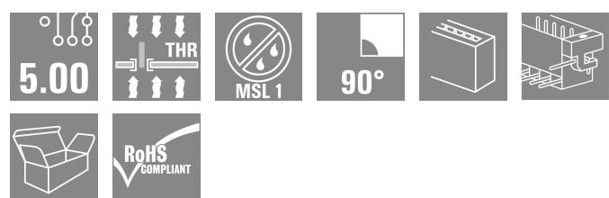
Hochtemperaturfeste Stiftleiste mit Verpackung in Box oder Tape. Im Tape mit 1,5 mm Lötstift optimiert für die Automatenbestückung. Lötstift 3,2 mm für Reflow- und Wellenlötanwendungen geeignet. Die Stiftleisten sind beschriftbar und können kodiert werden. HC = High Current.
