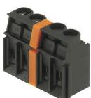
Die maximale Spannung basiert auf dem Mindestabstand. Zwischenplatten erhöhen die Luft- und Kriechstrecken zwischen unterschiedlichen Potenzialen und ermöglichen höhere Nennspannungen oder eine klare Trennung z. B. von Netz- und Niederspannungen bzw. unterschiedlicher Schutzbereiche. Die Schwalbenschwanzverbindung sorgt für schnelle Montage und festen Sitz. Weitere Merkmale sind:
