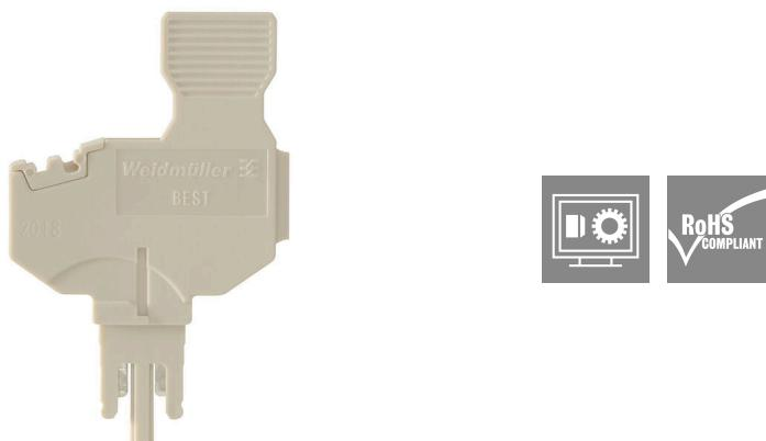
Der Bauelementestecker dient dem integrieren einer elektronischen Komponente in einer Trennreihenklemme. Nach dem Einlöten der jeweiligen Komponente lässt sich der Stecker in den Trennbereich unserer Reihenklemmen integrieren und ändert dadurch die Trennklemme zu einer Reihenklemme mit integrierter elektronischen Komponente.
