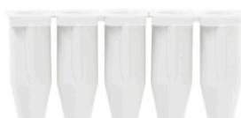
Durch den Einsatz von Reduzierhülsen wird das Anschließen von Leitern kleinerer Querschnittsbereiche vereinfacht. Leiter können sicher, ohne Abspleißen der Litzen, in die Klemmstelle eingeführt werden. Der Leiter wird durch den Einsatz der Reduzierhülse in der Mitte der Leitereinführung zentriert.
