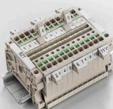
Die Bezeichnungsträger bieten die Möglichkeit der zusätzlichen Aufnahme von Standard Markierern im Raster von 5 bzw. 5.1 mm. Die gewinkelten Aufnahmen lassen sich wahlweise über miteinander verrasten und lassen sich in allen Standard Markierungsanälen der Klippon® Connect Reihenklemmen montieren. Passende Markierer typen befinden sich unter dem jeweiligen Zubehör der Bezeichnungsträger.
