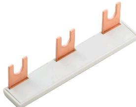
Die Verteilung oder Vervielfältigung eines Potentials auf benachbarte Reihenklemmen wird über eine Querverbindung realisiert. Zusätzlicher Verdrahtungsaufwand lässt sich so einfach vermeiden. Auch bei ausgebrochenen Polen ist weiterhin eine Kontaktsicherheit in den Reihenklemmen gewährleistet. Unser Portfolio bietet steck- und schraubbare Querverbindungssysteme für Reihenklemmen an.
