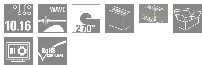
Einreihige High Performance Stifteleiste, polverlustfrei anreichbar oder mit patentiertem Flansch zur schnellen, werkzeuglosen Verriegelung. Höchste Bedienungs- und Betriebssicherheit durch 100% fehlstecksicheres Steckgesicht, einzigartige Kodervielfalt und Zusatzbefestigung im Flansch. Stiftlänge mit 3,5 mm optimiert für den Wellenlötprozess, Steckrichtung 270° zu den Lötstiften.
