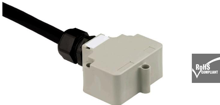
M12 Verteiler werden in allen möglichen Ausführungen angeboten. Die 4,6 oder 8 M12 Steckplätze sind 4 oder 5 polig. Der Sammelabgang ist wahlweise ausgeführt als Festkabelvariante, Haubenvariante zum Selbstanschließen oder mit M23. Weiterhin gibt es einige besondere Ausführungen. So gibt es 1 zu 1 Verteiler für die freie Wahl der Anschlüsse oder auch Verteiler, die für die Ex Zone 1 zugelassen sind.
