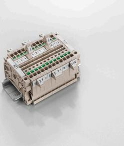
Die Bezeichnungsträger bieten die Möglichkeit der zusätzlichen Aufnahme von Standard Markierern im Raster von 5 bzw. 5.1 mm. Die gewinkelten Aufnahmen lassen sich wahlweise über miteinander verrasten und lassen sich in allen Standard Markierungskanälen der Klippon® Connect Reihenklemmen montieren. Passende Markierer typen befinden sich unter dem jeweiligen Zubehör der Bezeichnungsträger.
