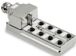
Einige Applikationen benötigen eine komplette Schirmung vom Sensor bis zur Steuerung. Dies erreichen SAI-Verteiler in Metall-Ausführung. Den Verteilern liegt eine EMV Verschraubung bei. Auf Initiator-LEDs wurde verzichtet.
