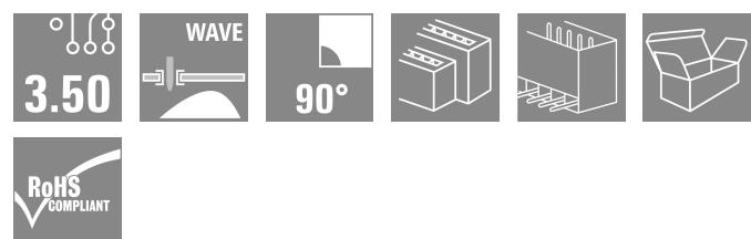
Doppelstöckige Stiftleiste für Wellenlötverfahren im Raster 3,50 mm. Die Stiftleiste steht in offener, geschlossener und Flanschversion zur Verfügung. Die Stiftleisten bieten Platz für Beschriftungen und können kodiert werden. Verpackung im Karton.
