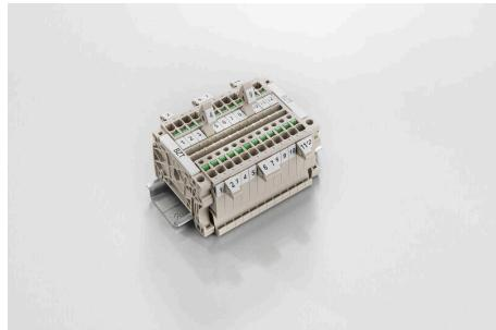
Die Bezeichnungsträger bieten die Möglichkeit der zusätzlichen Aufnahme von Standard Markierern im Raster von 5 bzw. 5.1 mm. Die gewinkelten Aufnahmen lassen sich wahlweise über miteinander verrasten und lassen sich in allen Standard Markierungsanälen der Klippon® Connect Reihenklemmen montieren. Passende Markierer typen befinden sich unter dem jeweiligen Zubehör der Bezeichnungsträger.
