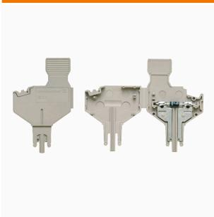
Der Bauelementstecker dient dem integrieren einer elektrischen Komponente in einer Trennreihenklemme. Nach dem Einlöten der jeweiligen Komponente lässt sich der Stecker in den Trennbereich unserer Reihenklemmen integrieren und ändert dadurch die Trennklemme zu einer Reihenklemme mit integrierter elektronischen Komponente.
