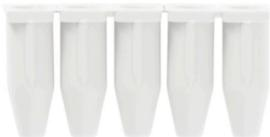
Durch den Einsatz von Reduzierhülsen wird das Anschließen von Leitern kleinerer Querschnittsbereiche vereinfacht. Leiter können sicher, ohne Abspießen der Litzen, in die Klemmstelle eingeführt werden. Der Leiter wird durch den Einsatz der Reduzierhülse in der Mitte der Leitereinführung zentriert.
