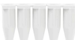
Durch den Einsatz von Reduzierhülsen wird das Anschließen von Leitern kleinerer Querschnittsbereiche vereinfacht. Leiter können sicher, ohne Abspleißen der Litzen, in die Klemmstelle eingeführt werden. Der Leiter wird durch den Einsatz der Reduzierhülse in der Mitte der Leitereinführung zentriert.
