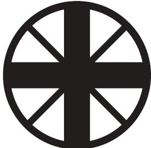
Kreuzschlitz-Schraubendreher, Typ Pozidriv, SDK PZ DIN
