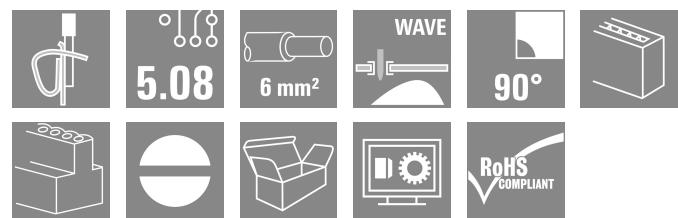
Trennelement mit Prüfabgriff, Leiterplattenklemme mit bewährtem Zugbügelanschluss im Raster 5,08 mm, Leiterabgangsrichtung in 90°-Ausführung. Für Leiterquerschnitte bis 6,0 mm<sup>2</sup> geeignet.
