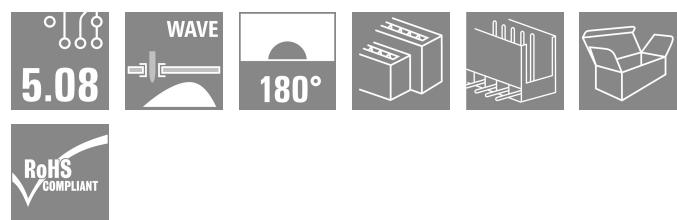
Stiftleisten mit optimierter Lötstiftlänge für Wellenlötanwendungen. Die Stiftleisten bieten Platz für Beschriftungen und können kodiert werden. HC = High Current.
