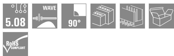
Stiftleisten mit optimierter Lötstiftlänge für Wellenlötaanwendungen. Die Stiftleisten bieten Platz für Beschriftungen und können kodiert werden. HC = High Current.
