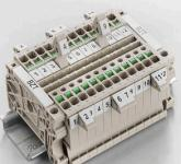
Die Bezeichnungsträger bieten die Möglichkeit der zusätzlichen Aufnahme von Standard Markierern im Raster von 5 bzw. 5.1 mm. Die gewinkelten Aufnahmen lassen sich wahlweise über miteinander verrasten und lassen sich in allen Standard Markierungsanälen der Klippon® Connect Reihenklemmen montieren. Passende Markierer typen befinden sich unter dem jeweiligen Zubehör der Bezeichnungsträger.
