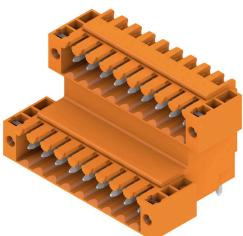
Doppelstöckige, versetzt angeordnete Stifteleiste für Wellenlötverfahren im Raster 3,50 mm. Die Stifteleiste steht in geschlossener und Flanschversion zur Verfügung. Die Stifteleisten bieten Platz für Beschriftungen und können kodiert werden.
