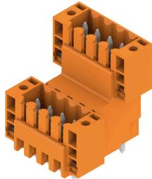
Doppelstöckige, versetzt angeordnete Stifteleiste für Wellenlötverfahren im Raster 3,50 mm. Die Stifteleiste steht in geschlossener und Flanschversion zur Verfügung. Die Stifteleisten bieten Platz für Beschriftungen und können kodiert werden.
