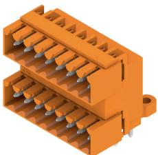
Doppelstöckige Stifteleiste für Wellenlötverfahren im Raster 3,50 mm. Die Stifteleiste steht in offener, geschlossener und Flanschversion zur Verfügung. Die Stifteleisten bieten Platz für Beschriftungen und können kodiert werden. Verpackung im Karton.
