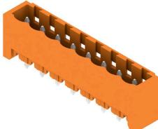
Stiftleisten aus glasfaserverstärktem Kunststoff mit gerader Abgangsrichtung optimiert für den Wellenlötprozess. Die Variante mit Flansch (F) lässt sich zur Verschraubung mit dem jeweiligen Gegenstück oder der Leiterplatte nutzen. Beim Einsatz der Lötfansch-Variante entfällt eine zusätzliche Verschraubung mit der Leiterplatte. Gleichzeitig werden die Lötstellen vor mechanischem Stress geschützt. Die Stiftleisten können manuell kodiert oder bereits vorkodiert bestellt werden. HC = High Current.
