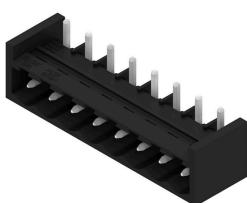
Hochtemperaturfeste, gerade, offene Stifteiste. Verpackung in Box oder Tape. Im Tape und mit 1,5 mm Lötstift optimiert für die Automatenbestückung. Lötstift 3,2 mm für Reflow- und Wellenlötanwendungen geeignet. Die Stifteisten sind beschriftbar und können kodiert werden. HC = High Current.
