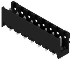
Hochtemperaturfeste, gerade, offene Stifteleiste. Verpackung in Box oder Tape. Im Tape und mit 1,5 mm Lötstift optimiert für die Automatenbestückung. Lötstift 3,2 mm für Reflow- und Wellenlötanwendungen geeignet. Die Stifteleisten sind beschriftbar und können kodiert werden. HC = High Current.
