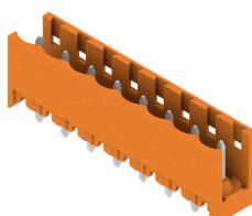
Stiftleisten aus glasfaserverstärktem Kunststoff mit gerader Abgangsrichtung optimiert für den Wellenlötprozess. Die Variante mit Flansch (F) lässt sich zur Verschraubung mit dem jeweiligen Gegenstück oder der Leiterplatte nutzen. Beim Einsatz der Lötflansch-Variante entfällt eine zusätzliche Verschraubung mit der Leiterplatte. Gleichzeitig werden die Lötstellen vor mechanischem Stress geschützt. Die Stiftleisten können manuell kodiert oder bereits vorkodiert bestellt werden. HC = High Current.
