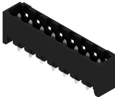
Hochtemperaturfeste Stifteiste mit Verpackung in Box oder Tape. Im Tape mit 1,5 mm Lötstift optimiert für die Automatenbestückung. Lötstift 3,2 mm für Reflow- und Wellenlötanwendungen geeignet. Die Stifteisten sind beschriftbar und können kodiert werden. HC = High Current.
