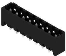
Hochtemperaturfeste Stiftleiste mit Verpackung in Box oder Tape. Im Tape mit 1,5 mm Lötstift optimiert für die Automatenbestückung. Lötstift 3,2 mm für Reflow- und Wellenlötanwendungen geeignet. Die Stiftleisten sind beschriftbar und können kodiert werden. HC = High Current.
