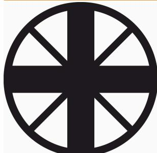
Kreuzschlitz-Schraubendreher, Typ Pozidriv, SDK PZ DIN
