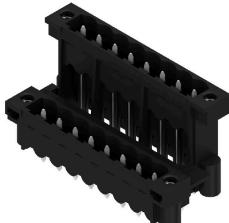
Hochtemperaturfeste, doppelstöckige, seitlich versetzte, Stiftleiste mit Flansch bzw. Lötfansch. Lötstift 1,5 mm für Reflowlötanwendungen geeignet. Lötstift 3,2 mm für Reflow- und Wellenlötanwendungen geeignet. Die Stiftleisten bieten Platz für Beschriftungen und können kodiert werden.
