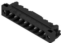
Hochtemperaturfeste Stifteleiste mit Verpackung in Box oder Tape. Im Tape mit 1,5 mm Lötstift optimiert für die Automatenbestückung. Lötstift 3,2 mm für Reflow- und Wellenlötanwendungen geeignet. Die Stifteleisten sind beschrifftbar und können kodiert werden. HC = High Current.
