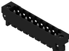
Hochtemperaturfeste Stifteleiste mit Verpackung in Box oder Tape. Im Tape mit 1,5 mm Lötstift optimiert für die Automatenbestückung. Lötstift 3,2 mm für Reflow- und Wellenlötanwendungen geeignet. Die Stifteleisten sind beschrifftbar und können kodiert werden. HC = High Current.
