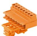
Stiftstecker mit Schraubanschluss in Zugbügeltechnik für Leiteranschluss. Mit Rastfüßen werden die Stiftsteckern auf Tragscheinen montiert. Die Stiftsteckern bieten Platz für Beschriftungen und können kodiert werden.
