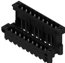
Hochtemperaturfeste, doppelstöckige, seitlich versetzte, Stiftleiste mit Flansch bzw. Lötplansch. Lötstift 1,5 mm für Reflowlötanwendungen geeignet. Lötstift 3,2 mm für Reflow- und Wellenlötanwendungen geeignet. Die Stiftleisten bieten Platz für Beschriftungen und können kodiert werden.
