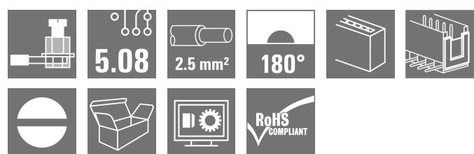
Stiftstecker mit Schraubanschluss in Zugbügeltechnik für Leiteranschluss. Die Stiftsteckern bieten Platz für Beschriftungen und können kodiert werden.
