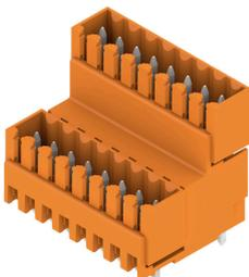
Doppelstöckige, versetzt angeordnete Stiftleiste für Wellenlötverfahren im Raster 3,50 mm. Die Stiftleiste steht in geschlossener und Flanschversion zur Verfügung. Die Stiftleisten bieten Platz für Beschriftungen und können kodiert werden.
