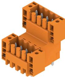
Doppelstöckige, versetzt angeordnete Stiftleiste für Wellenlötverfahren im Raster 3,50 mm. Die Stiftleiste steht in geschlossener und Flanschversion zur Verfügung. Die Stiftleisten bieten Platz für Beschriftungen und können kodiert werden.
