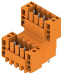
Doppelstöckige, versetzt angeordnete Stiftleiste für Wellenlötverfahren im Raster 3,50 mm. Die Stiftleiste steht in geschlossener und Flanschversion zur Verfügung. Die Stiftleisten bieten Platz für Beschriftungen und können kodiert werden.
