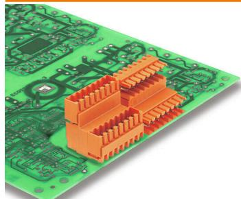
Doppelstöckige, versetzt angeordnete Stifteleiste für Wellenlötverfahren im Raster 3,50 mm. Die Stifteleiste steht in geschlossener und Flanschversion zur Verfügung. Die Stifteleisten bieten Platz für Beschriftungen und können kodiert werden.
