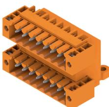
Doppelstöckige Stiftleiste für Wellenlötverfahren im Raster 3,50 mm. Die Stiftleiste steht in offener, geschlossener und Flanschversion zur Verfügung. Die Stiftleisten bieten Platz für Beschriftungen und können kodiert werden. Verpackung im Karton.
