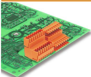
Doppelstöckige, versetzt angeordnete Stiftleiste für Wellenlötverfahren im Raster 3,50 mm. Die Stiftleiste steht in geschlossener und Flanschversion zur Verfügung. Die Stiftleisten bieten Platz für Beschriftungen und können kodiert werden.
